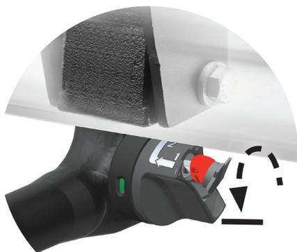
Nach Gebrauch stecken Sie den Schlüssel ein und drehen ihn, um die Kugelstange zu entriegeln.
