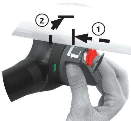
Drücken Sie die Taste und halten Sie sie diese gedrückt, während Sie den Knopf in Richtung des Autos drehen, bis die Signal-farbe auf Rot wechselt.
