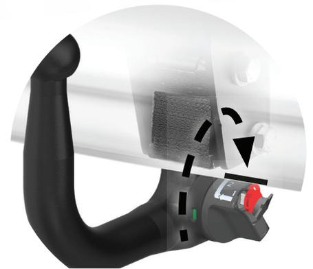
Verriegeln Sie die Kugelstange , indem Sie den Schlüssel drehen. Jetzt können Sie den Schlüssel entfernen und sind bereit loszufahren.
