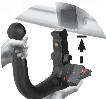
Setzen Sie die Kugelstange ein.
